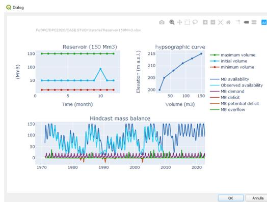
Fig. 2: Esempio of plot delle serie temporali applicato all'elemento RESERVOIR, con un run di tipo hindcast, tratto dal tutorial
